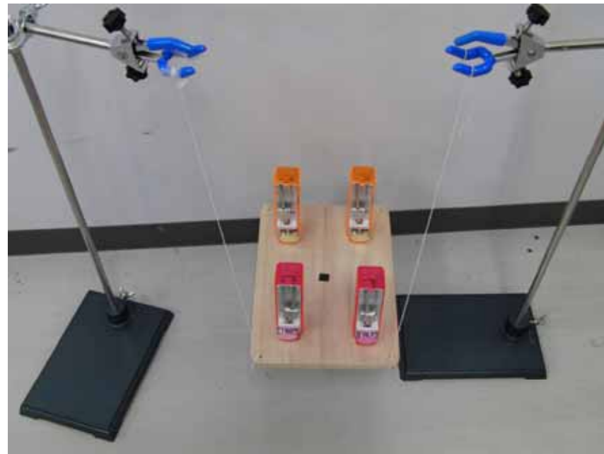
図3. 凧糸でまな板を吊りメ トロノームに乗せる
